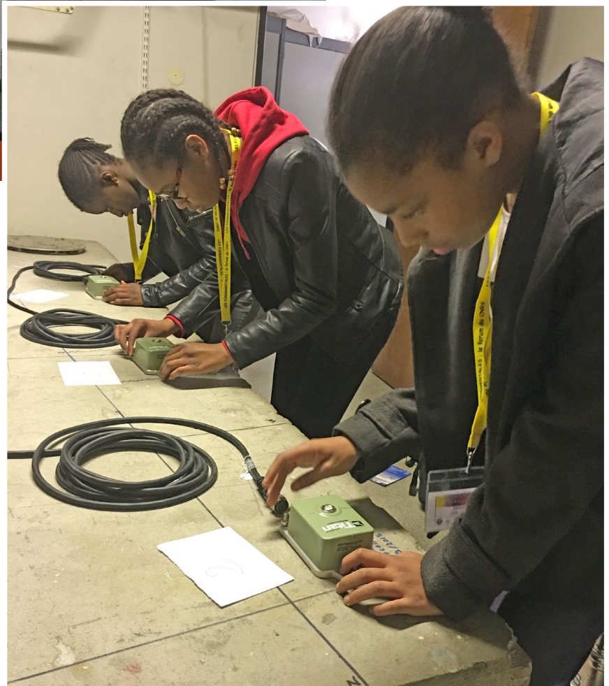
Etalonnage et paramétrage de sismomètres © CNRS/Antoine Schlupp
